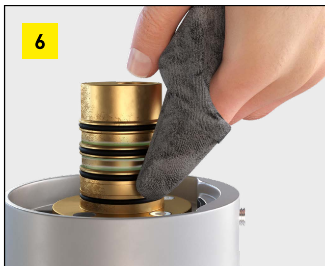
Drehzapfen mit Spiritus o.ä. reinigen.
