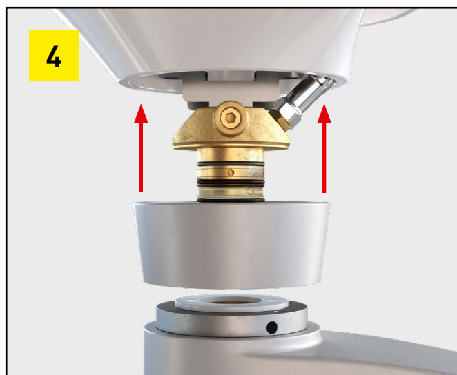
Waschbecken nach oben abheben und Abdeckhülse abnehmen.
