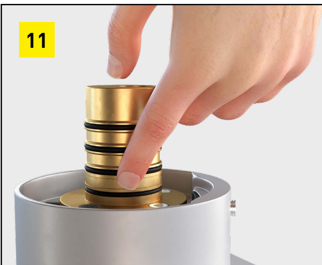
Drehzapfen mit dem beigelegten Fett neu einfetten. Zum Einfetten keinen Lappen verwenden – mit dem Finger einstreichen. Bitte beachten, dass nur das mitgelieferte Fett verwendet werden darf.
