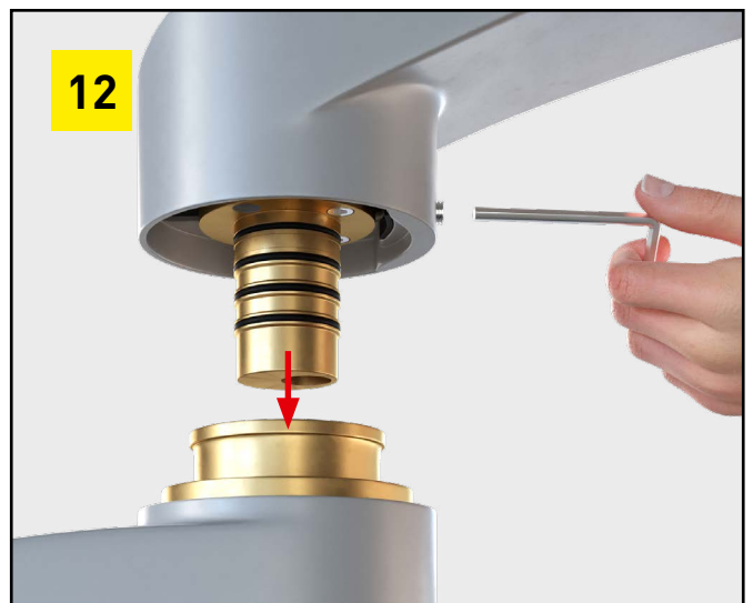
Schwenkarm unter leichten Drehbewegungen wieder einsetzen. Gelenkbremse zurückdrehen (rechts herum), bis der Schwenkarm die normale Leichtgängigkeit erreicht hat.
