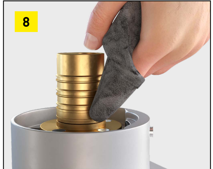
Drehzapfen ohne O-Ringe ebenfalls mit Spiritus o.ä. reinigen.
